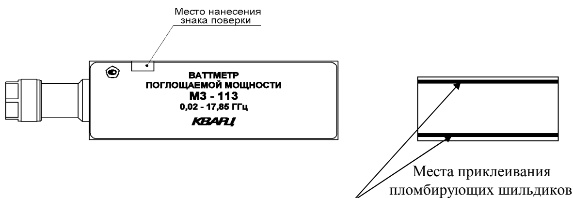
Рисунок 2 – Схема нанесения пломбирующего шильдика и знака поверки
