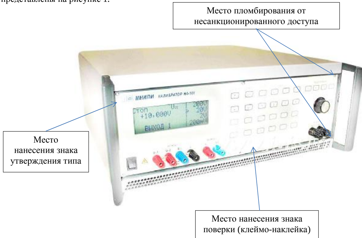
Рисунок 1 - Внешний вид калибратора и схема пломбировки от несанкционированного доступа
