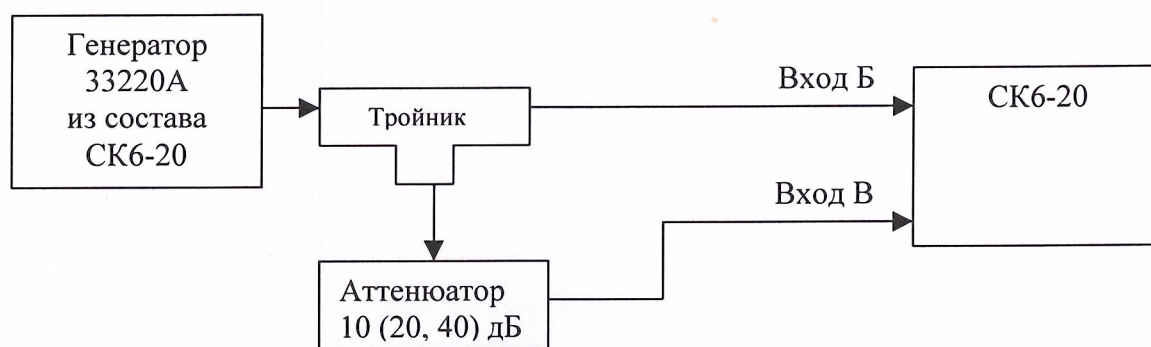
Рисунок 3 Проверка режима индикации коэффициента передачи и фазового сдвига четырехполюсников
