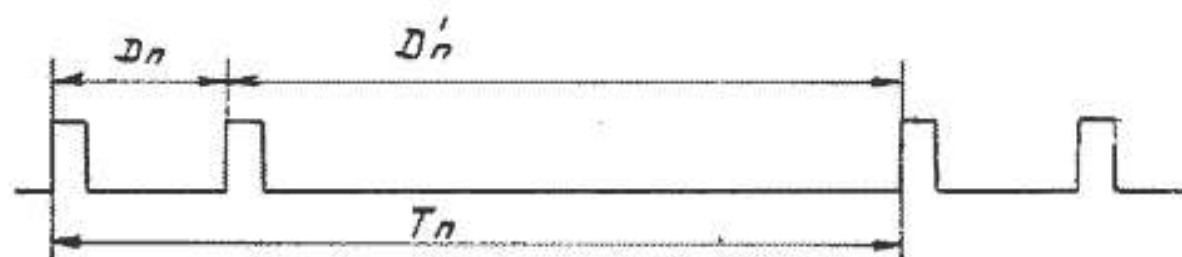
Временная диаграмма временного сдвига второго импульса пары относительно первого
