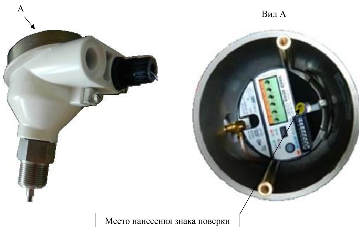
б) схема пломбирования уровнемера без показывающего устройства
