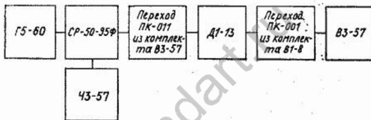
Рис. 9. Схема соединения аппаратуры при определении погрешности прибора на частоте 5 Гц
